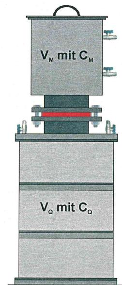
Unter „steady state“-Bedingungen gilt für die Messanordnung nach dem 2. Fick'schen Gesetz die folgende eindimensionale Diffusionsgleichung:
